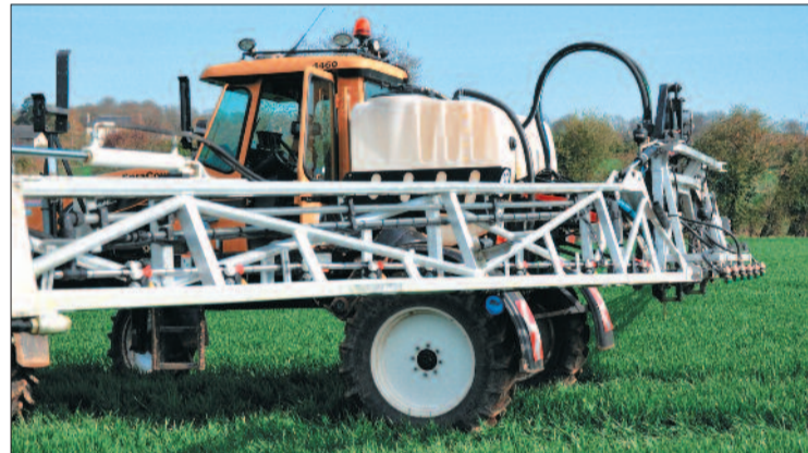
Les rampes aluminium (18, 24 et 28 m) sont légères avec une rigidité et une stabilité exceptionnelles. Elles sont munies d'un système de sécurité contrôlée qui allonge leur durée d'utilisation et améliore la fiabilité du pulvérisateur.
