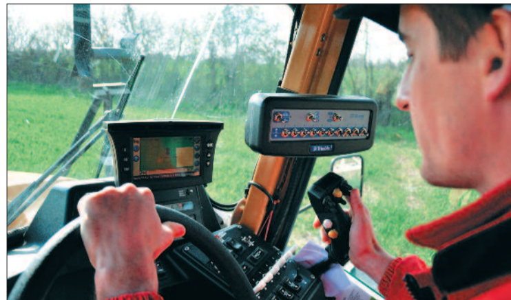
Le joystick intégré à la console de droite permet au conducteur d'accéder à de nombreuses fonctionnalités. Il permet la commande de la pompe de pulvérisation, celle des rampes et sections, le traceur à mousse et le réglage de la hauteur des rampes par simple poussée sur un bouton.
