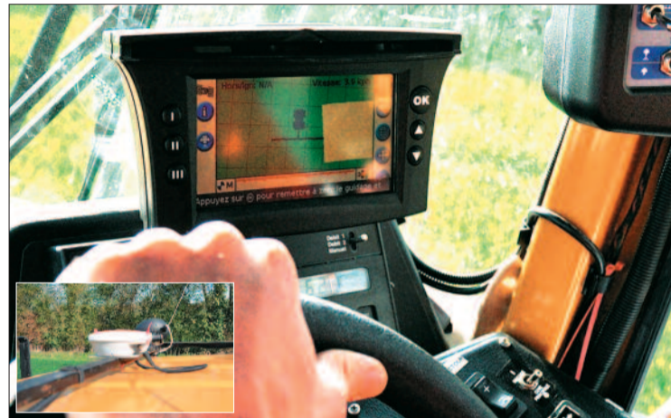
Grâce au GPS, le conducteur peut de la cabine couper par tronçon la pulvérisation. Une assurance aussi contre l'erreur humaine.
